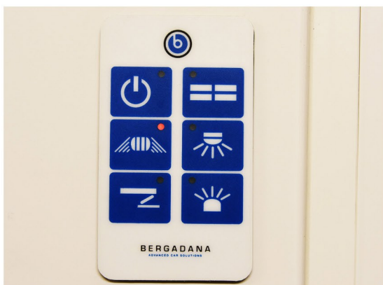
Мал. 22 - Панель керування пристроями заднього та бічних виходів з медичного салону.
